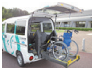
後部が車いすスペース 定員3名（石岡本所）
